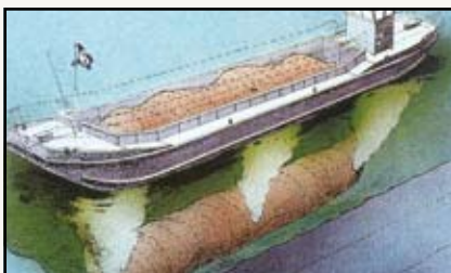
Largada de um sistema de Geocontainer® a partir de uma draga
